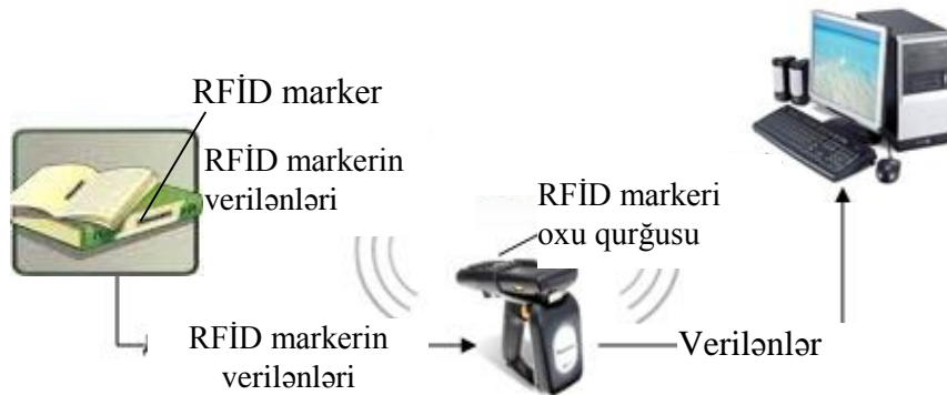
Şəkil 3. RFID sisteminin arxitektura sxemi
