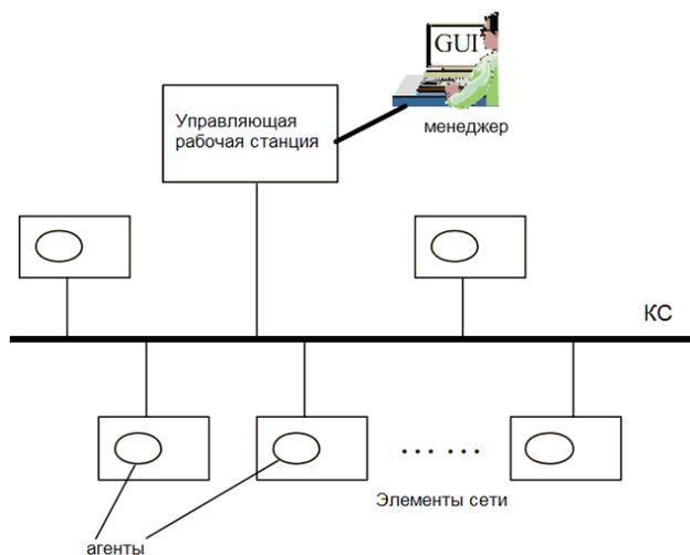
Рис.1. Компоненты типичной системы управления КС
