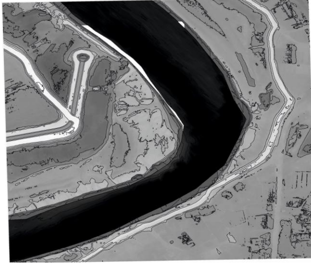
Şəkil 5. Spatial Analyst vasitəsi ilə konturların ayırd edilməsi (avtomatik deşifrətmə)
